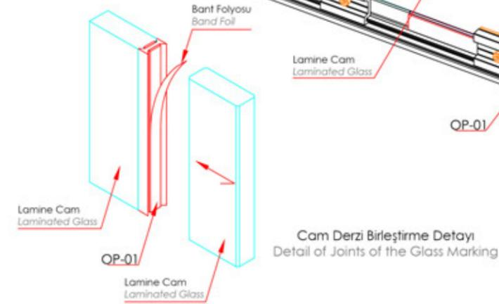
OP-01 cam derz plastiği ilk cama bandın folyosu sıyrılarak yapıştırılır, sonraki cam takılırken OP-01 cam derz plastiğinin diğer yüzündeki bandın folyosu sıyrılarak ikinci cam derz plastiğine doğru sürülerek yapıştırılır. Bu yapıştırma işlemi sırasında OP-01 cam derz plastiğinin yapışacağı yüzey kuru, temiz ve tozdan arındırılmış olmalıdır, bandın folyosu sıyrıldıktan hemen sonra yapıştırma işlemi gerçekleştirilmelidir.
